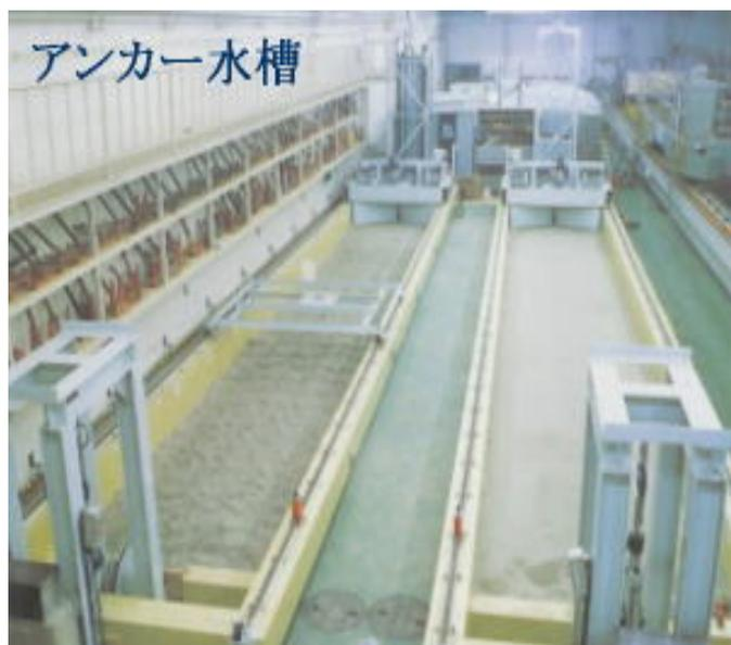
定速引張装置 : 速度 0.01m/s~0.1m/s
